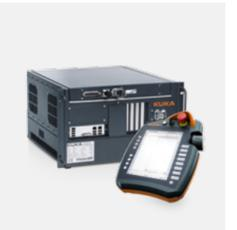
KUKA 优秀的品质、高度的灵活性和完美的技术使 KR 3 AGILUS 成为 3 公斤负载级别中的佼佼者，实现通过经实践检验的 SmartPAD 和 KR C4 compact 控制系统对机器人进行编程、控制和操作。
